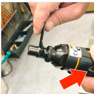
Podczas odkręcania nie należy trzymać narzędzia za korpus.
