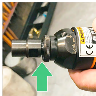
Należy zablokować obrót wrzeciona.
